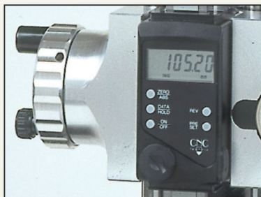
Bewährtes Meßsystem von Mitutoyo mit digitalem Datenausgang.
