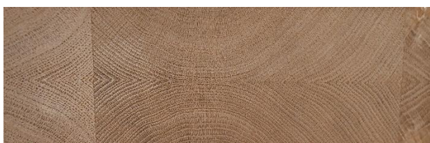
Kante mit der selben Lamelle aufgedoppelt
