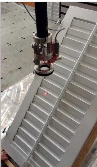
Mittels einer Hagelkanone wird von der EMPA der natürliche Hagelschlag simuliert.
