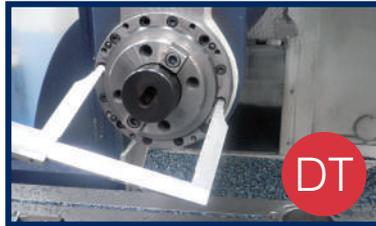
Medir cota DT de cabezal.
