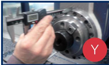
Medir profundidad del cabezal.
