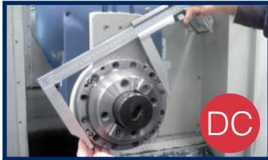
Medir cota DC de cabezal.
