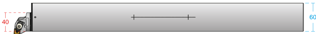
esempio di una testina CS40 montata su una barra di diametro maggiore (D 60) example of a CS40 head mounted on a larger diameter bar (D 60)
