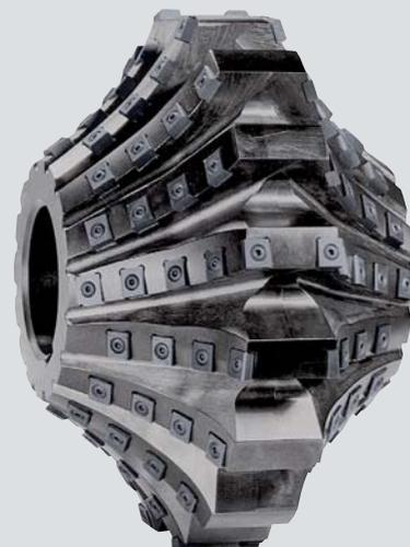
LMT Fette hat große Erfahrung in der Auslegung dieser Werkzeuge. Insbesondere für das Vorzerspanen wurden Schruppfräser hoher Leistungsfähigkeit für die unterschiedlichsten Bearbeitungsmaschinen entwickelt. Die Ausführungen aus Vollmaterial ist für den Einsatz auf konventionellen Räderfräsmaschinen ausgelegt. Für Verzahnungsmaschinen mit leistungsfähigen Motorfräsköpfen fertigen wir Fräser mit Wendepplatten (Kat.-Nr. 2675 und 2667).
