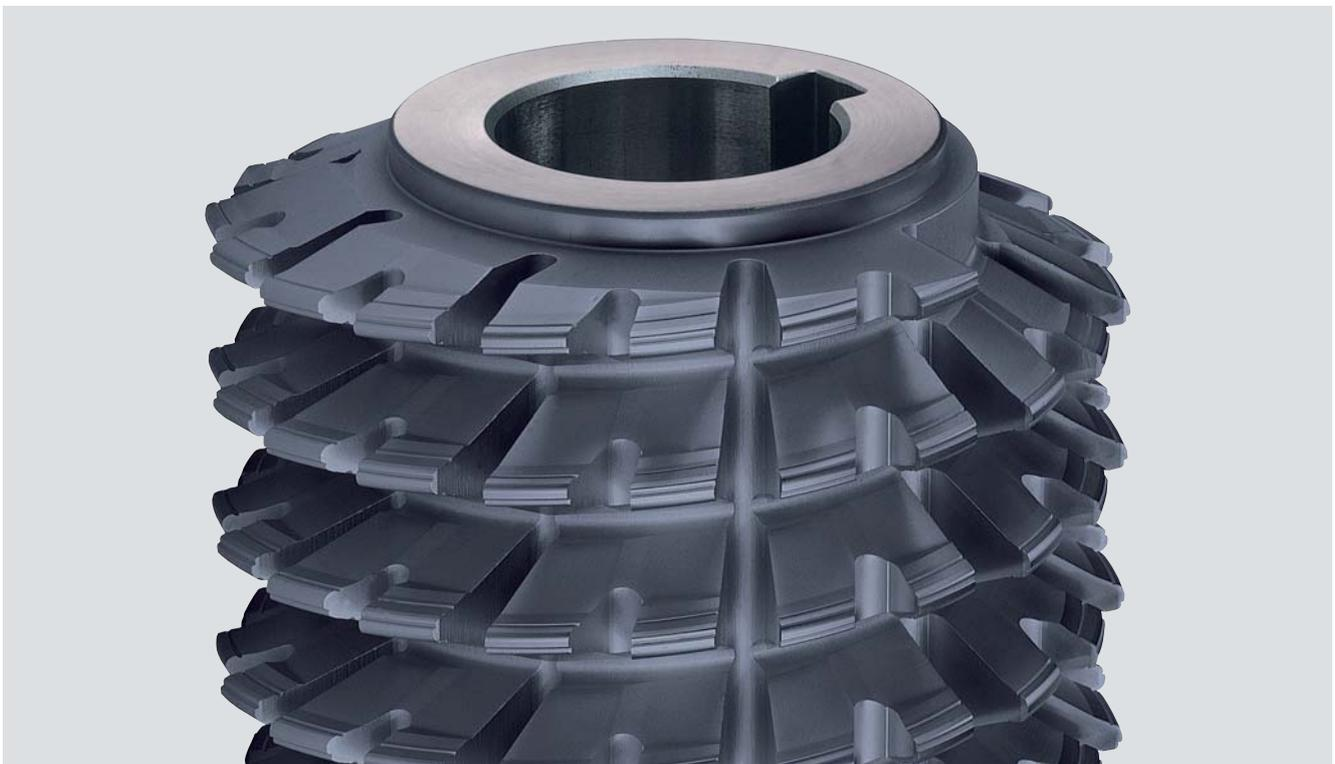
Diese Forderungen erfüllt der LMT Fette Räumzahn-Wälzfräser in idealer Weise mit seinen in der Höhe abgestuften Zähnen. Nur in jeder zweiten Zahnreihe haben die Fräserzähne die volle Profilhöhe. Die dazwischen liegenden Zähne sind auf etwa  $\frac{1}{3}$  der Profilhöhe begrenzt.
