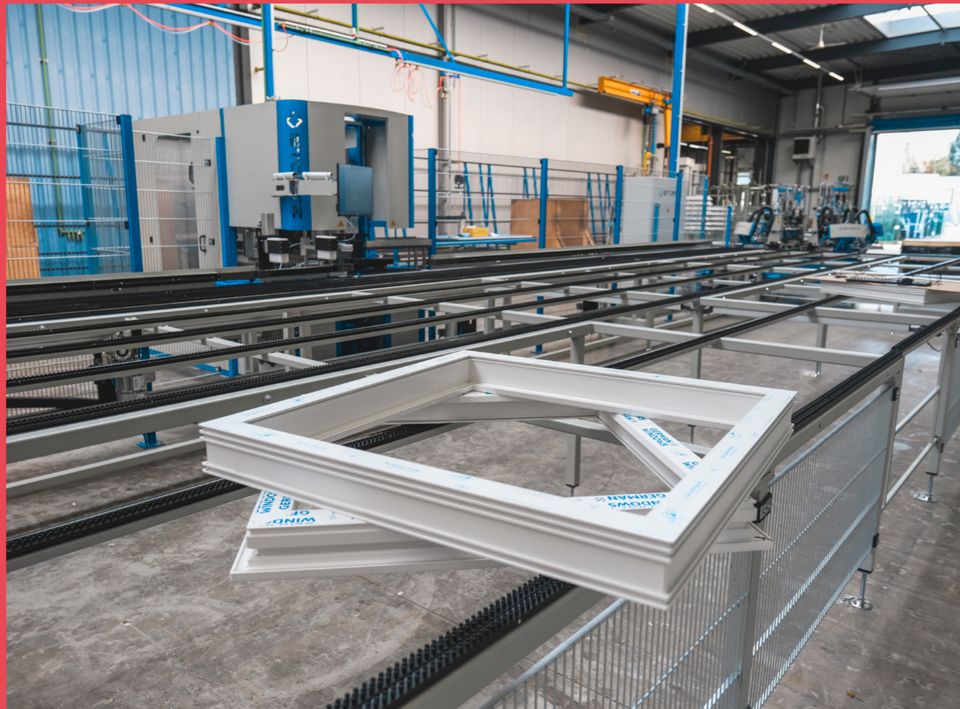
Ci-dessus : L'un de nos centres d'usinage 100% automatisé pour les profilés PVC. Ci-contre : notre table de travail pour des dimensions XXL (jusqu'à 6,5 m pour les coulissants !)
