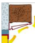
KIT DE PROTECTION DE POUTRE Pour poutre bois pour inserts et foyers-inserts
