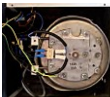
Resistencia fuera del tanque para evitar daños de corrosión
