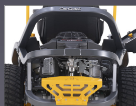
CHÂSSIS TUBULAIRE 50X50 MM
