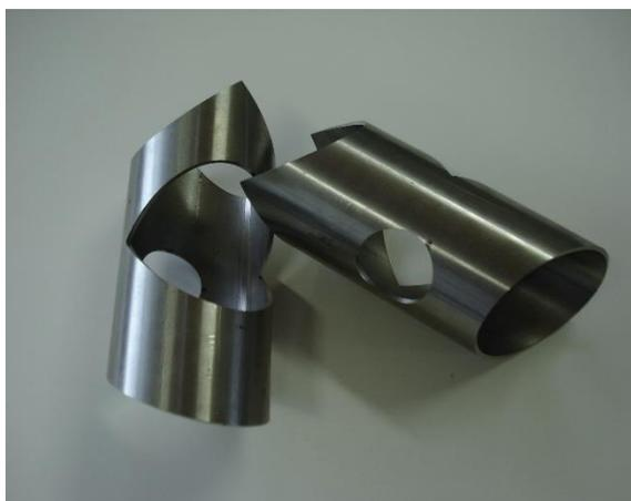
Découpe laser de tubes pour passage de câbles, pliage ou développement de barrière dans le domaine de la serrurerie
