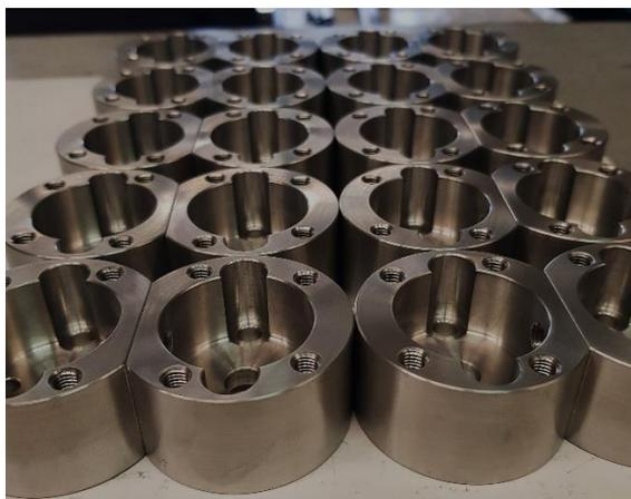
Usinage complet de pièces rondes, reprisent en fraisage
