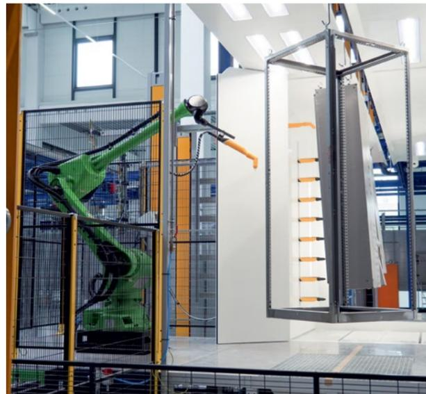
In der neuen Lackiererei kann Häwa auch komplexe Bauteile effizient automatisch beschichten.
