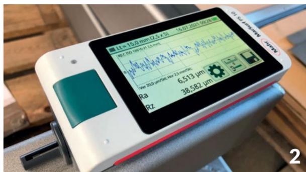
ten. Die Versuchsreihe zeigte, dass kantige Strahlmittel in vielen Fällen Vorteile bei der Erzielung der gewünschten Oberflächenstruktur brachten.
