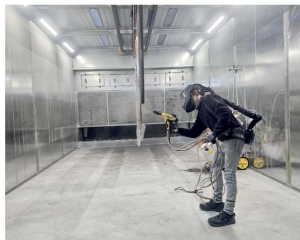
Um flexibel unterschiedlichste Lackiergüter beschichten zu können setzt Dalmer auf manuelle Lackierung.
