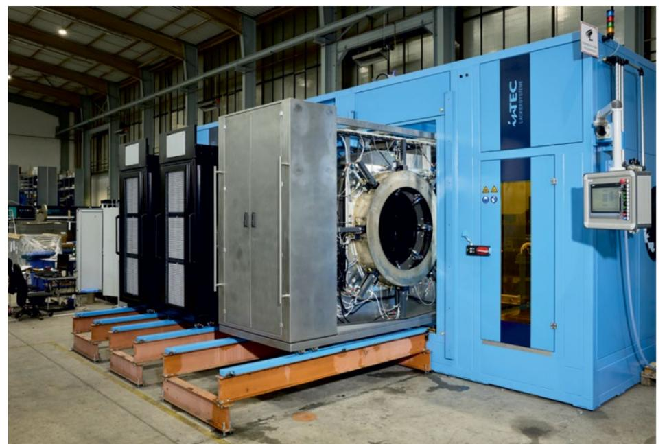
Die gesamte Anlage ist kompakt installierbar und durch ein wartungsfreundliches intelligentes Schubkastensystem dennoch vollumfänglich zugänglich.
