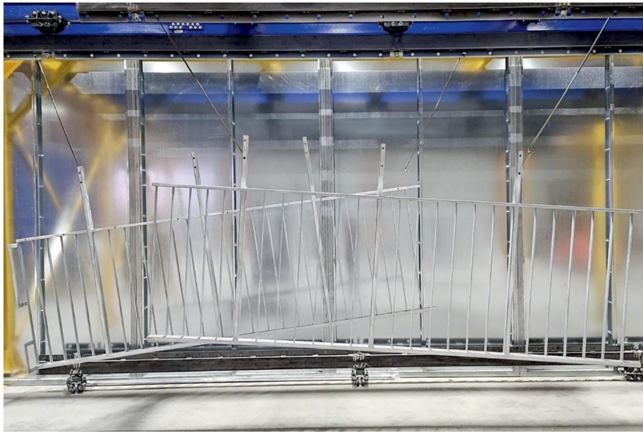
Bis zu 6 m Länge kann Dalmer Pulverbeschichtung beschichten.
