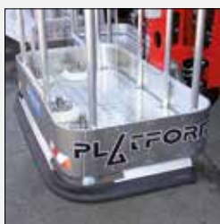
Dispositif anti-collision en caoutchouc conducteur appliqué au panier.
