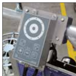
Dispositif INTERPHONE pour la communication homme-sol avec le personnel de le panier.
