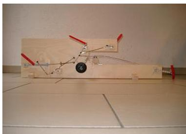
Bild 8: Fallflug mit aufgestellten Klappen um die Bauchlage sicherzustellen
