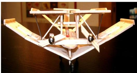
Sept. 2006 Flugmodell 1:10 bis Rohbau fertiggestellt (Version Modell MV1). Dieses Modell hatte ein schwenkbares HLW. Nach unten geschwenkt konnten die Seitenrudder auch im Fallflug die geographische Ausrichtung steuern. Einher mit der resultierenden Steuerhebelposition wird die V-Ausrichtung der unteren Flügel variiert.
