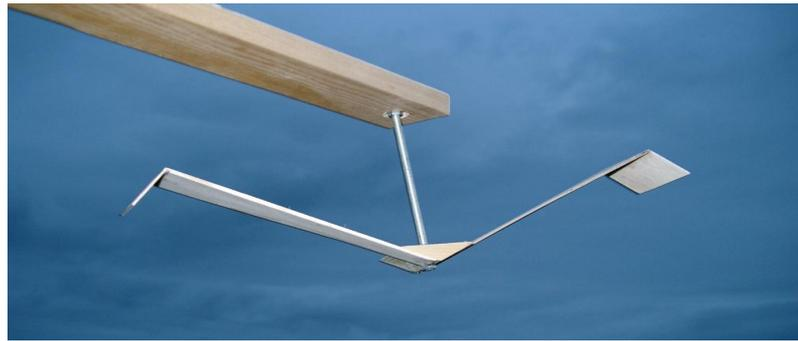
Die folgende Variante war zwar technisch einfacher ausgeführt. Zur Erreichung der notwendigen Rotationsgeschwindigkeit war weiterhin eine Anblasgeschwindigkeit von zirka 20 km/h notwendig.
