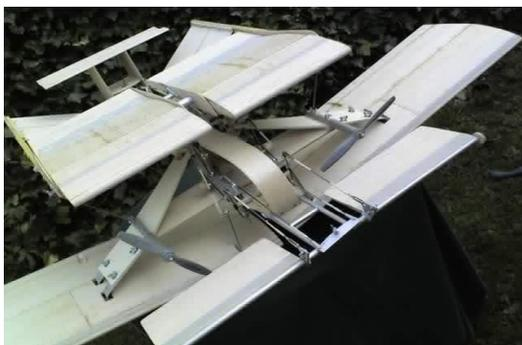
Die nachfolgende Bildsequenz veranschaulicht die einseitige Klappen- und HLW-Stellung der Flugmanöver. Die Mechanik und die Klappen sind doppelt ausgeführt (für die linke und rechte Seite). Das HLW wird von beiden „Mechaniken“ angesteuert. Das Resultat ist ein HLW-Mischgetriebe. Mit den Canard-Flügel wird die horizontale Ausrichtung gesteuert.
