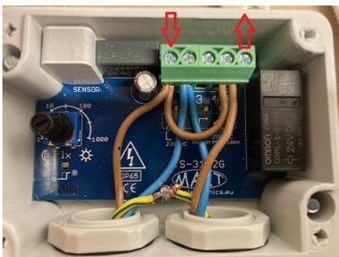
Der Eingang links mit 230 Volt ist die Speisung, von einer wasserfesten Steckerverbindung kommend. Der invertierte Ausgang rechts, geht auf die Wasserpumpe. Da in diesem Gerät keine Erdungsklemme vorgesehen ist, wurde die Eingangs-Erdung mit der Ausgangs-Erdung verlötet.
