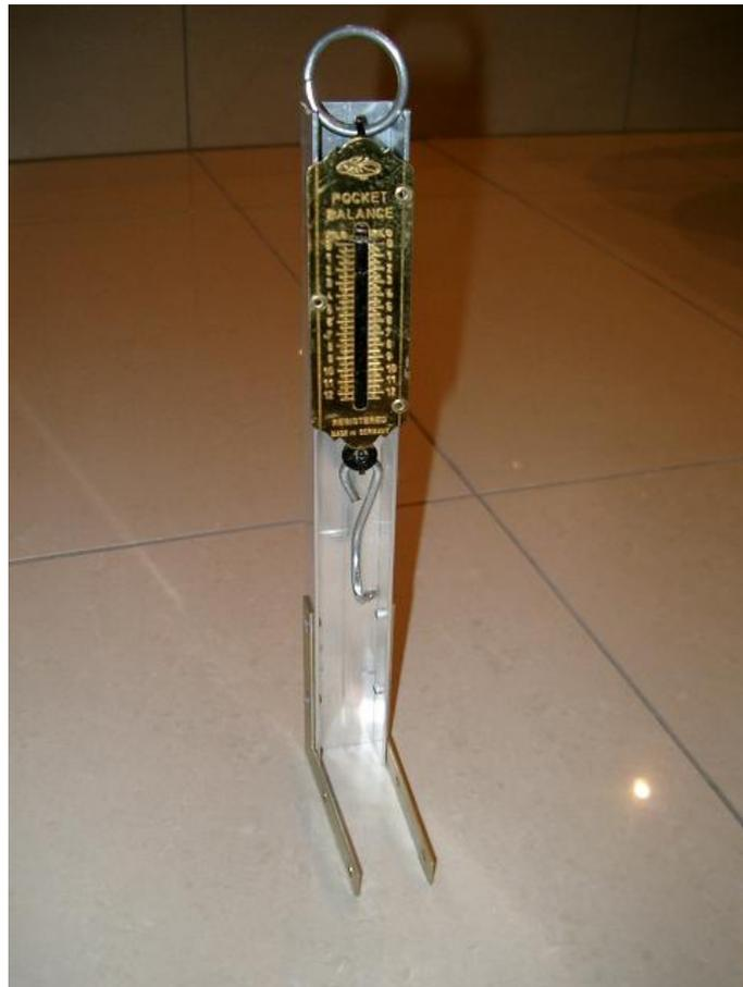
*Flügel-Spann-Vorrichtung: die Flügel-Spann-Seile auf 60 N, respektive auf 6 kg Zug vor spannen.*
