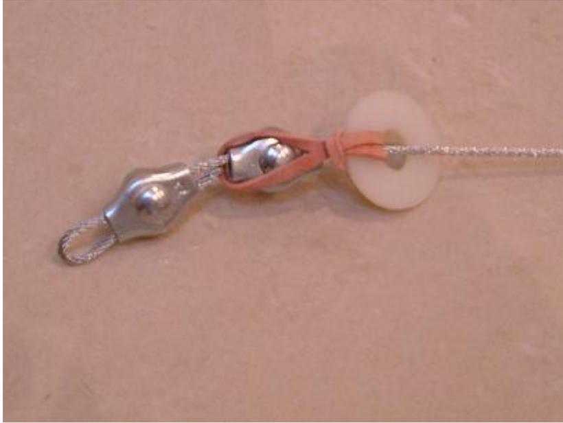
*Drei Stahlseile 1,5 Millimeter mit je 1,7 kN Zugkraft (170 kg),
