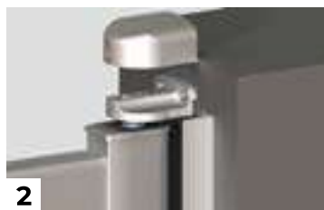
2 Gond haut caréné, axe inox Ø16 mm, laqué à la couleur du portail avec profil d'occultation laqué à la couleur du portail.
