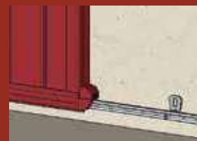
Réglette support en partie basse pour porte-fenêtre
