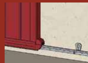
Réglette support en partie basse pour porte-fenêtre
