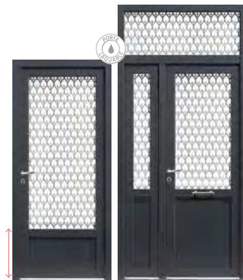
VEGA 1 Vitrage feuilleté sablé classe 2 avec sérigraphie grise, motif fleur de lys gris RAL 9007 uniquement. Positionnement variable de la traverse dans la hauteur de la porte pour modifier la proportion vitrée. À droite, ensemble en 2650 x 1200 mm composé d'une porte en 2150 x 800 mm avec bâton de moréchal, associée à un semi-fixe coordonné de 400 mm et une imposte vitrée de 500 mm. Option : ploxage couleur gris 7016. Ud : 14
