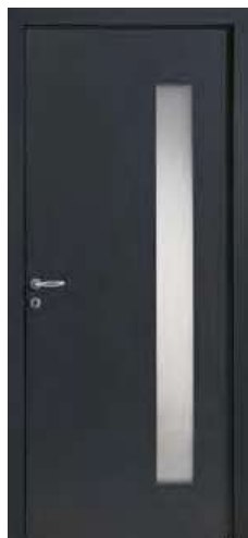
CYTISS 6 Triple vitrage feuilleté sablé classe 2. Design rainuré 2 faces identiques. Gris 7016 satiné. Ud : 1,3
