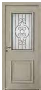
CORDEY 2 Vitrage feuilleté sablé classe 2 avec sérigraphie couleur gris RAL 9007 uniquement. Gris perle 2800 texturé. Ud : 1.2
