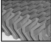
Os separadores de gotas são fabricados com lâminas de PVC tendo três ou quatro mudanças de direcção e limitam a perda de gotas a menos de 0,002% do caudal de água em circulação.
