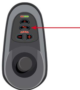
Abbildung 12: Taste „Hupe“ auf dem Bedienmodul“
