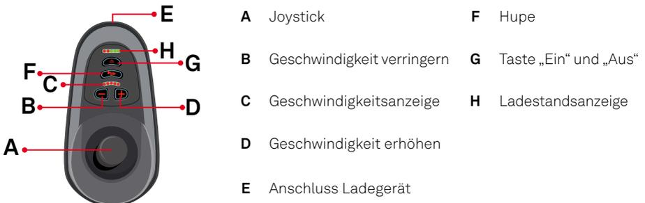
Abbildung 2: Das Bedienmodul in der Übersicht
