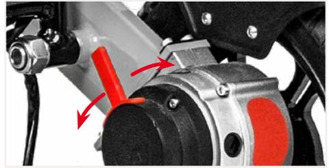
Abbildung 15: Aktivieren oder Deaktivieren der Feststellbremsen
