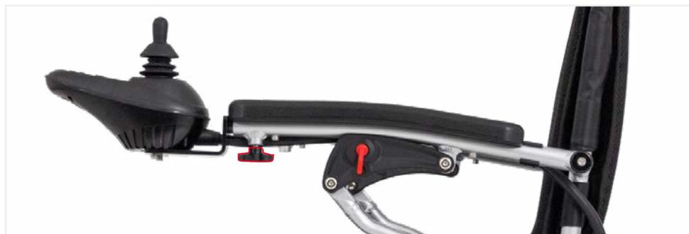
Abbildung 6: Das Bedienmodul fixieren
