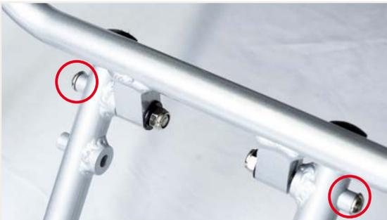
Abbildung 11: Die Schrauben an der Fußstütze
