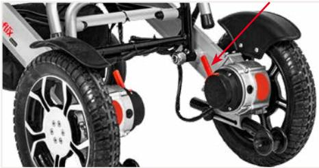
Abbildung 14: Position der Feststellbremsen
