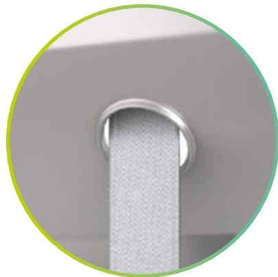
1 Punzonature bordate. Grazie alle punzonature bordate il nastro Texband non viene danneggiato dal bordo tagliente della punzonatura e può quindi funzionare senza problemi e a lungo.
