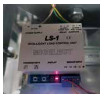
Ylikuormavaaka (Vakiona 100 ONE ja Double Decker malleissa )
