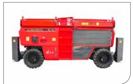
Parapets pliants : pratiques pour le stockage, le transport et le passage par des portes et des ascenseurs étroits
