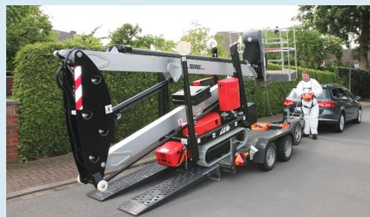
La LEO15GT, légère, peut être remorquée par des équipements standards. Grâce à la commande à câble, le chargement est rapide et facile.
