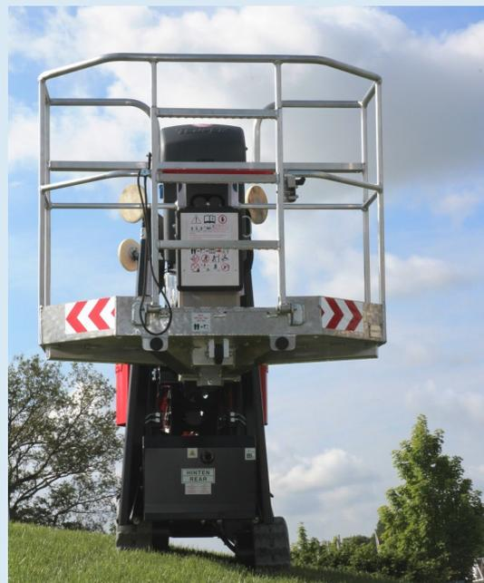
Le châssis à chenilles ajustables en option permet le déplacement en toute sécurité à flanc de coteau et accroît la stabilité au sol.
