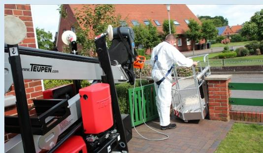
Le panier détachable monté sur roulettes facilite les manoeuvres lors de passages étroits.
