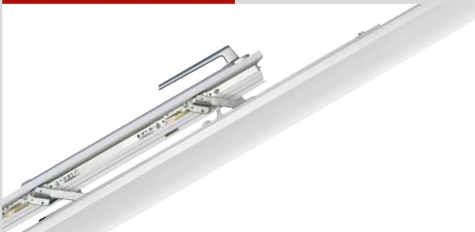
Durch die Zwangssteuerung von Scheren und Laufwagen wird der Flügel über eine einfache 90°-Drehbewegung des Hebels oben und unten synchron geöffnet.
