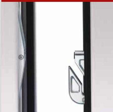
Zwei Verschlusshaken erzeugen die 15 mm Verschluss- und Öffnungsbewegung des Flügels zwangsgesteuert. Kunststoffanschläge dämpfen das Anschlaggeräusch.
