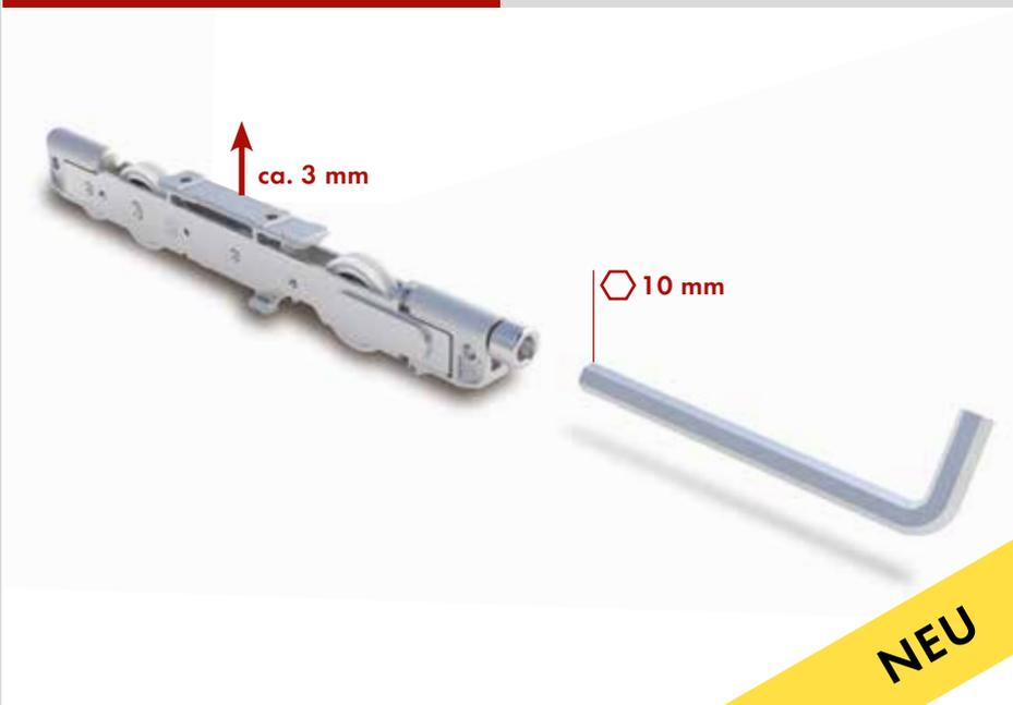
Der höheneinstellbare Laufwagen bietet die Möglichkeit, den Schiebeflügel hinten um ca. 3 mm anzuheben. Dies ermöglicht das einfache und schnelle Ausrichten des Schiebeflügels bei der Montage.
