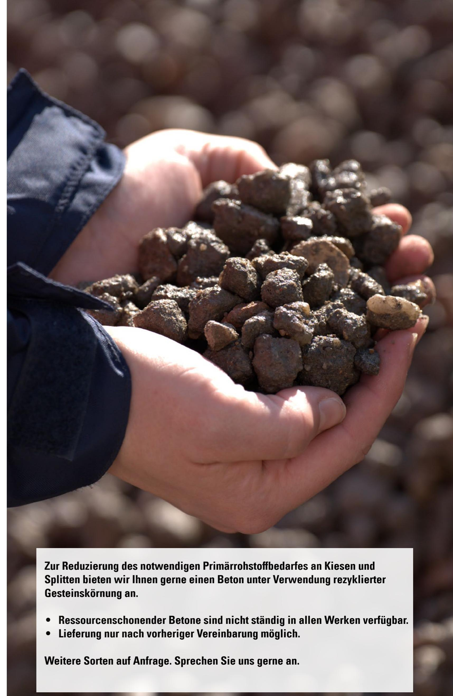
Zur Reduzierung des notwendigen Primärrohstoffbedarfes an Kiesen und Splitten bieten wir Ihnen gerne einen Beton unter Verwendung recycelter Gesteinskörnung an.
