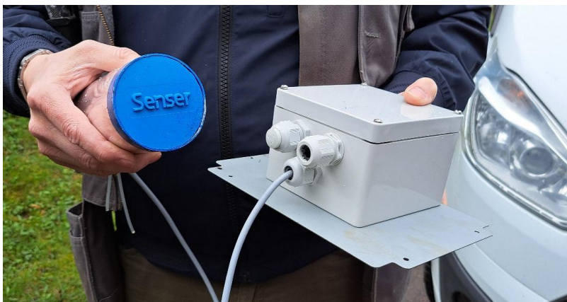
Kuva 4. Itseoppiva ilmanvaihdon säätöyksikkö Sensor.
