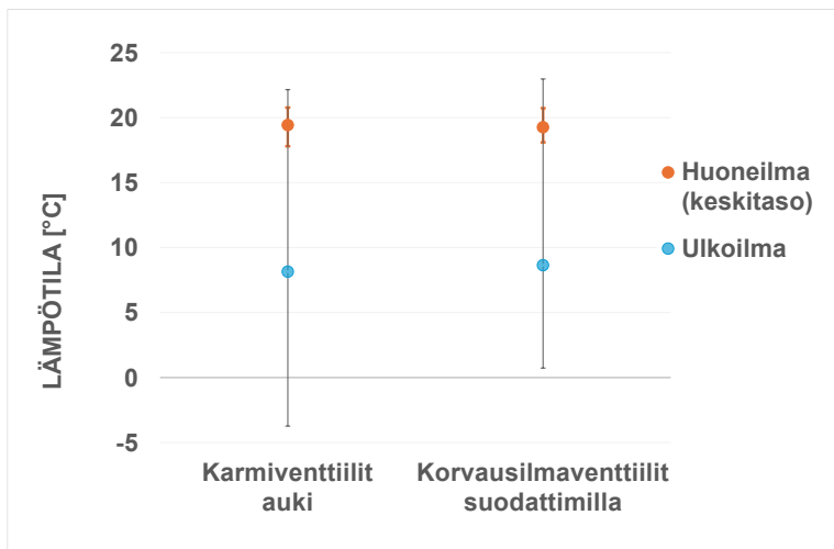
Kuva 14. Tuloilmareitin vaikutus huoneen lämpötilaan käytettäessä karmiventtiileitä tai korvausilmaventtiileitä suodattimilla ulkoilman lämpötilan keskiarvon ollessa n. 8,5 °C.
