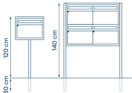
Die Löcher im Briefkasten für die Montage der Monostütze bzw. der Seitenstützen werden in unserem Haus vorgebohrt. Bei der Wandmontage müssen die Löcher bauseits gebohrt werden.
