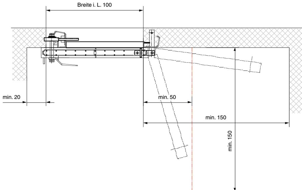
Türen nach Vorschrift versetzen und in geschlossenem Zustand ausbetonieren.
