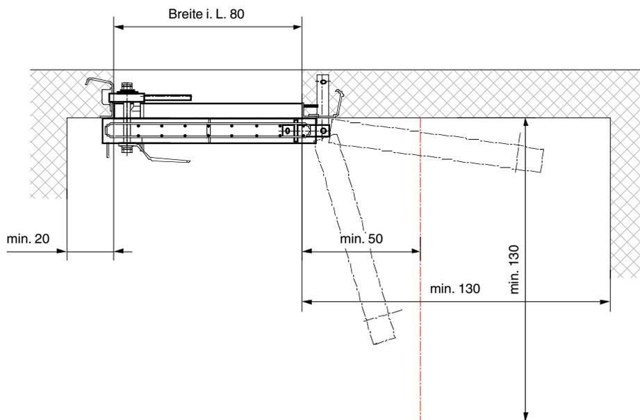
Türen nach Vorschrift versetzen und in geschlossenem Zustand ausbetonieren.
