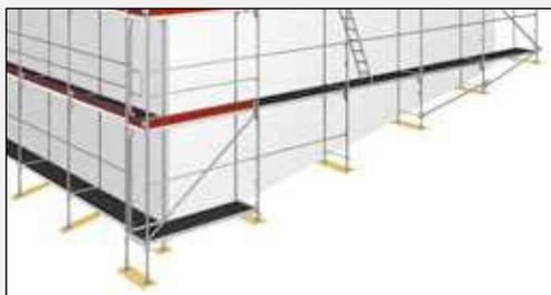
O andaime pode ser adaptado às condições particulares do terreno por meio de estruturas de 0,66 - 1,00 e 1,50 m. A montagem deve começar sempre pelo ponto mais alto. A estrutura de 1,50 x 1,09 m possui dois bolsos para grades de segurança, o que a torna adequada para utilização em andaimes para fachadas.
