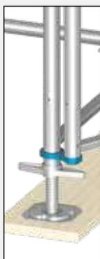
O adaptador de canto, para andaimes circulares e soluções de canto, simplifica consideravelmente esta fase de montagem. É colocado nas bases antes da montagem da estrutura inferior e, assim, pode montar duas estruturas uma ao lado da outra sem necessidade de uma braçadeira na parte inferior. Ambos os quadros são automaticamente alinhados à mesma altura.
