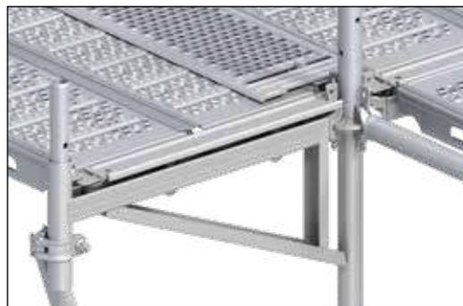
Situação de montagem: **mísula LW 1c** 0,73 m (em cima) ou alternativamente **horizontal "U"** de 0,73 m em conjunto com **diagonal para mísula 3** de 2,05 m. (esquerda).
