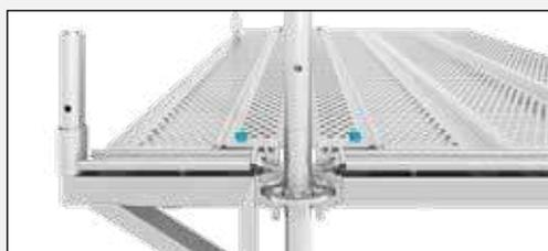
A **lâmina cobre-espaços 320 4** pode ser utilizada entre duas plataformas de andaimes dos sistemas Blitz e Allround. O espaço máximo a cobrir deve ter uma largura máxima de 20 cm.
