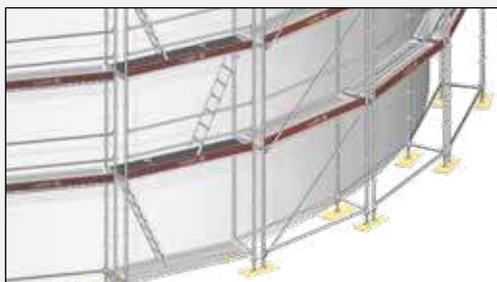
a **rodapé horizontal "U" angular LW 3** é utilizada para andaimes circulares de grande diâmetro fabricados com uma base comum (apenas um vertical interior).
