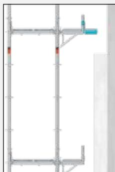
A **mísula de extensão "U" 4** é utilizada para uma extensão rápida da superfície de trabalho. Por exemplo, na instalação de sistemas compostos de isolamento térmico exterior. Colocam-se simplesmente no espigão das mísulas pré-montadas. Não necessita de ferramentas.
