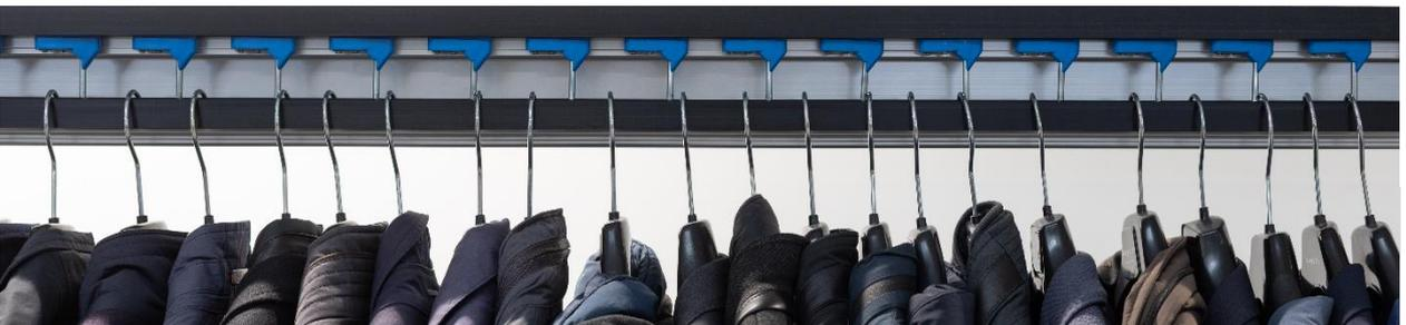
Der PIN Förderer HRP ist ein Transport- und Sortierförderer für an Bügeln hängende Gegenstände, z. B. Bekleidung.
