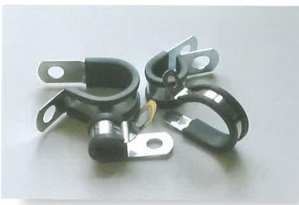
Unsere P-CLIPS sind in zwei verschiedenen Weiten für Schraubbolzen von 6mm sowie 10mm verfügbar, sowie wählbar in verzinktem Stahl oder Edelstahl 18/8. Es gibt zwei Arten von TPE-Umlagen mit je unterschiedlichen Betriebstemperaturen.
