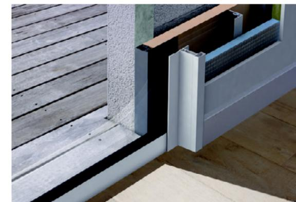
Refolement pré-isolé et pré-étanché en usine,
