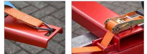
Sicherung... ..durch Spanngurte
