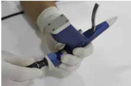
4. Schließen Sie das andere Ende des Kabels an eine der Anschlussbuchsen der elektrischen Stromkonsole Best.-Nr. 5025/5020 an (siehe Best.-Nr. 5025-5020 Gebrauchsanleitung für zusätzliche Informationen zu den Einstellungen der Konsole).
