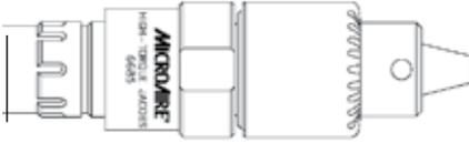
Diese Jacobs®-Bohrerkupplung nimmt MicroAire-Jacobs-Spiralbohrer der Serien 8051 und 8054 mit Durchmessern von 1,0 mm bis 6,5 mm auf.
