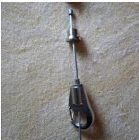
1. Enfiler le câble au travers de la pièce mâle et du mousqueton
