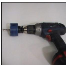
Carotter le panneau en entamant le carottage par le côté « face visible » avec une scie cloche (*pour le diamètre de carottage, voir la fiche d'installation du fabricant des spots*)
