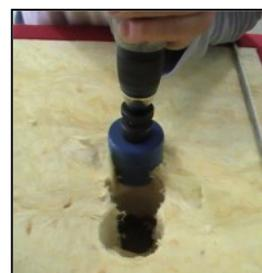
Avant de procéder à cette opération, ramener la mèche de la scie cloche au même niveau que les dentelures de la cloche et carotter ensuite pour enlever quelques centimètres de matière. Il faut laisser environ 2 cm de matière pour permettre aux ressorts de se rabattre.
