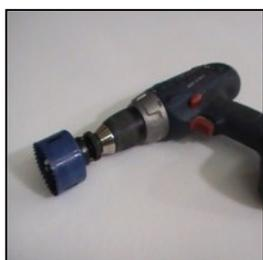
Les panneaux étant trop épais (4 ou 6 cm) pour permettre aux ressorts des luminaires de se rabattre, il faut amincir l'épaisseur du panneau aux endroits de rabat des ressorts en carottant par le dos.
