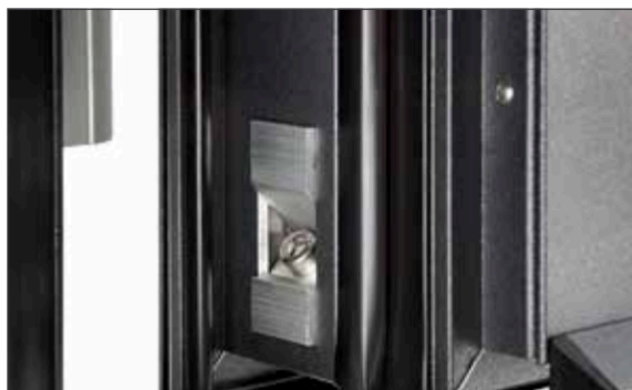
Stabile Eckverbindungen Profile auf Gehung verschraubt, verklebt und verbolt
