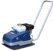
SWEPEC F75 Bensiinimoottorilla varustettu maantiivistäjä hiekan, sepin ja soran tiivistämiseen. Paino: 75 kg
