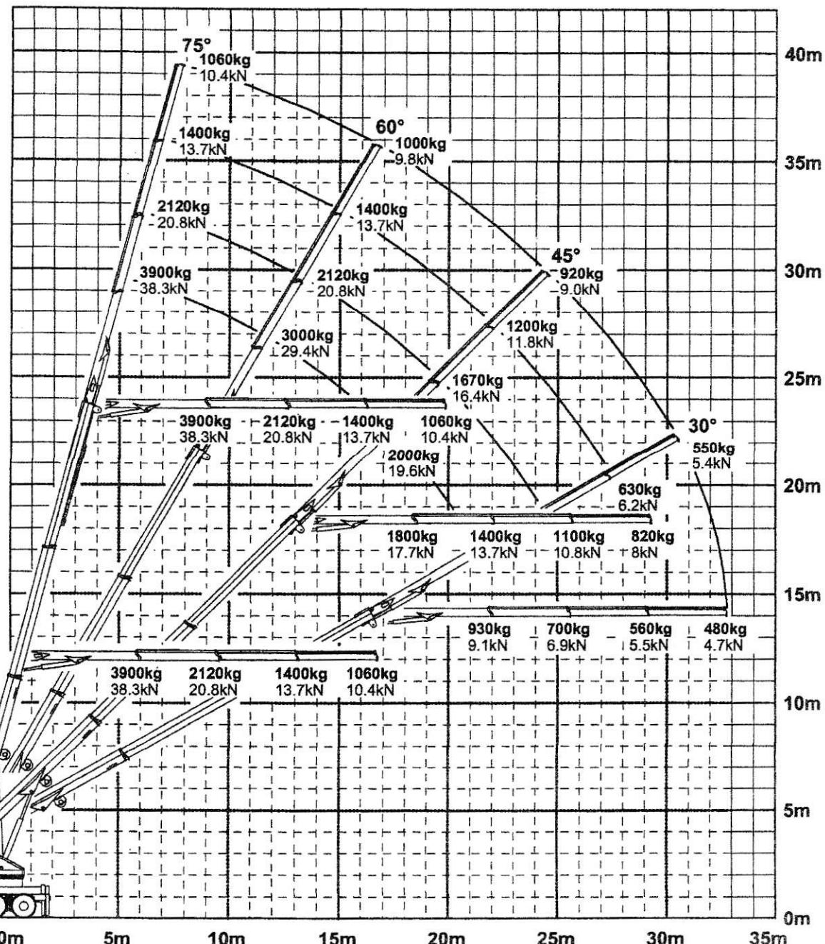
Im Seilwindenbetrieb verringern sich die Traglasten um das Eigengewicht des Hakengeschirrs.
