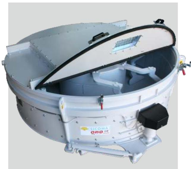
Rendimiento vibrado de 500 litros a 3,5 m<sup>3</sup> de hormigón por ciclo
