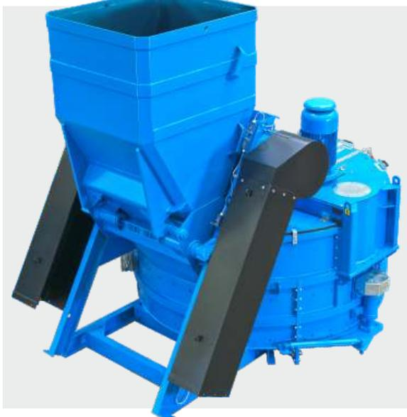
Rendimiento vibrado de 100 litros a 4 m<sup>3</sup> de hormigón por ciclo
