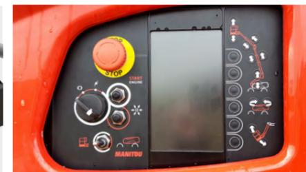
Le grand écran du poste bas offre des informations complémentaires à celui du poste haut pour l'opérateur et permet aux techniciens de réaliser un diagnostic rapide, de consulter la mémoire de la machine et bien d'autres fonctions grâce à une navigation simple et intuitive.
