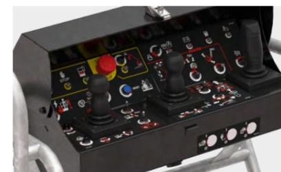
Tous les mouvements principaux sont gérés via des joysticks proportionnels pour une approche plus précise. Poste de commandes standardisé sur toute la gamme ATJ.
