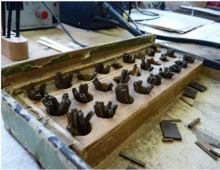
▲ Plombs de lettrage destinés à la dorure à chaud.
