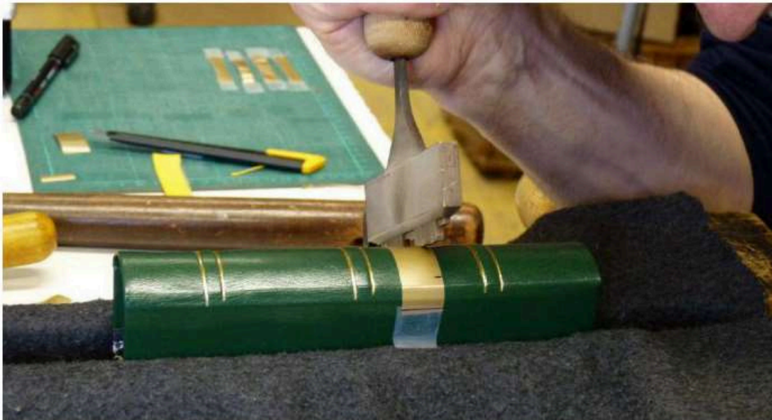
▲ Marquage par dorure à chaud du titre et du nom de l'auteur au dos du livre.
