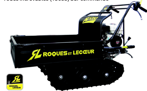
2390 € TRANSPORTEUR À CHENILLES RL 5350 RL (7) Moteur RL R 180. Charge 300 kg. Bennage manuel. Plateau extensible. Vitesses 3 AV + 1 AR. PLATEAU (929153) ou BENNE (931532) Sur commande. Existe en modèle RL 5550 H : Moteur Honda GP 200. Charge 500 kg. Bennage hydraulique. PLATEAU (929158) ou BENNE (929156) Sur commande : 3790 €
